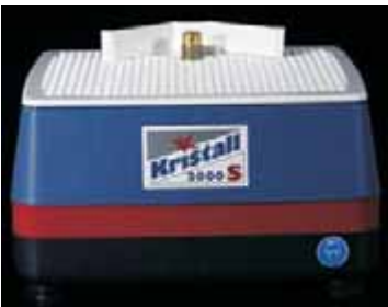
30 101 50 Schleifmaschine KRISTALL 2000S 280 x 235 mm Arbeitsfläche / work surface, 100 W, 2800 U/min, Präzisionskugellager / dual precision ball bearings, eingebaute Schleif- wasserpumpe / built in grinding water pump, incl. Thermoschutz / thermal protection, Spritzschutz / splash guard und 19 mm Schleifkopf / dia- mond bit
