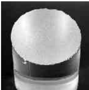
Schleifscheibe / Diamond disc Körnung / Grit 100
