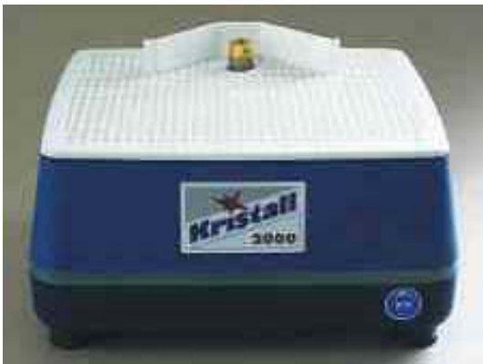
30 101 00 KRISTALL 2000 280 x 235 mm Arbeitsfläche / work surface, 170 W, 2255 U/min, Präzisionskugellager / dual precision ball bearings, eingebaute Schleifwasserpumpe / built in grinding water pump, incl. Thermoschutz / thermal protection, Spritzschutz / splash guard und 19 mm Schleifkopf / diamond bit
