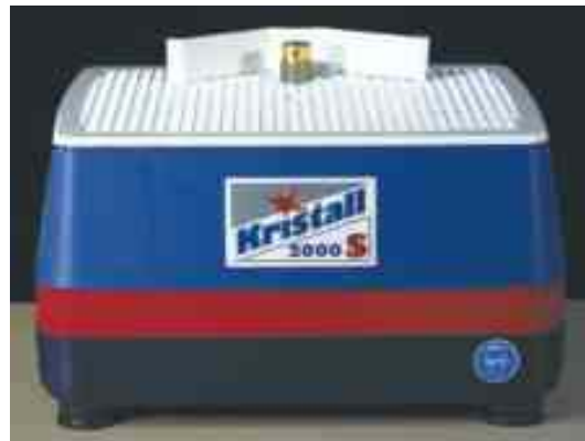
30 101 50 KRISTALL 2000S (Powermotor) 280 x 235 mm Arbeitsfläche / work surface, 100 W, 2800 U/min, Präzisionskugellager / dual precision ball bearings, eingebaute Schleifwasserpumpe / built in grinding water pump, incl. Thermoschutz / thermal protection, Spritzschutz / splash guard und 19 mm Schleifkopf / diamond bit
